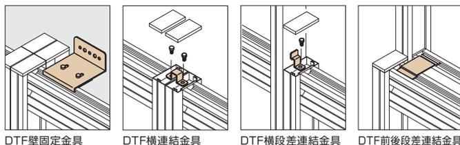
DTF壁固定金具 DTF横連結金具 DTF横段差連結金具 DTF前後段差連結金具
